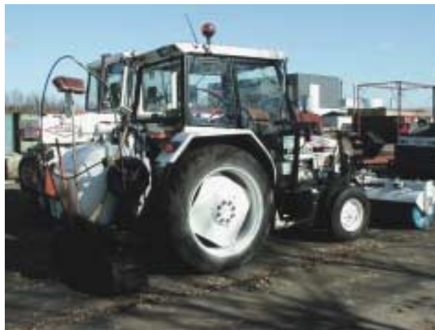
Figur 2. En almindelig traktor med en kalibreret sprøjtebom er anvendelig til forseglingsopgaver.
